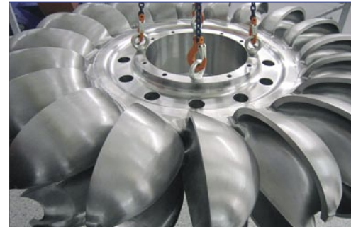
Ersatzlaufrad der Pelton-Turbine im neuen KW Vomperbach
